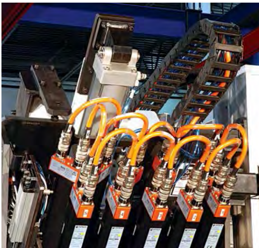
上图是10根智能轴的应用，9根跳接电缆，1根长电缆。
