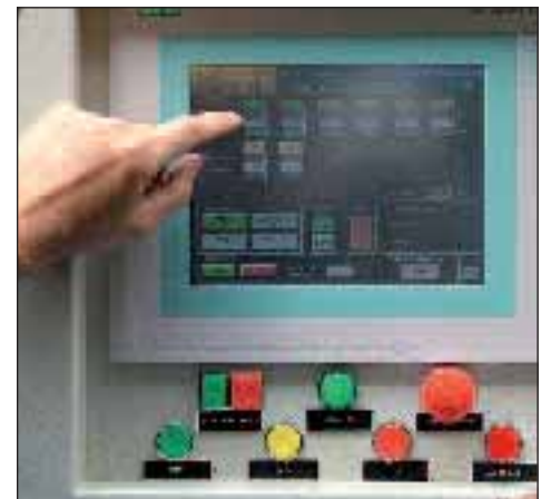
▲ EPS系列高级同步顶升系统PLC控制器控制台
